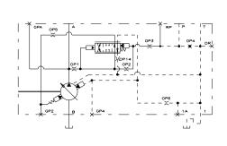
P-RNN/H CONTROL REMOTE CONTROL W/ HORSEPOWER LIMITER
